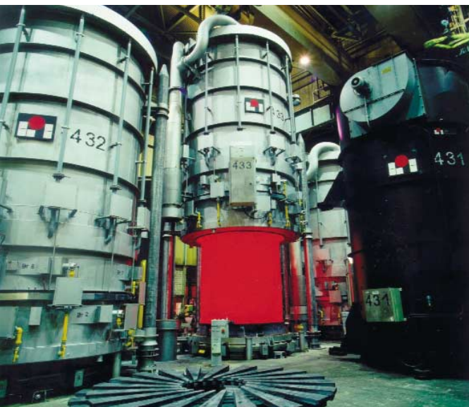
Haubenofenanlage für Stahlband. LOI ist einer der führenden Anbieter auf dem Gebiet der High-Performance-Hydrogen-Haubenofenanlagen.
